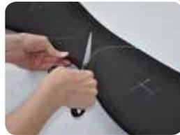
Die Schnittkanten werden schräg geschnitten, um eine Stufenbildung zu vermeiden.
